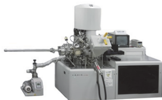
XPS(ESCA) : X線光電子分光装置
