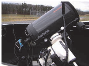
図2 アメリカ、NASAのゴダードスペースフライトセンターの観測所に設置した口径35cmのロボット望遠鏡
