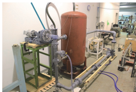
図2 ポンプ水車実験装置
