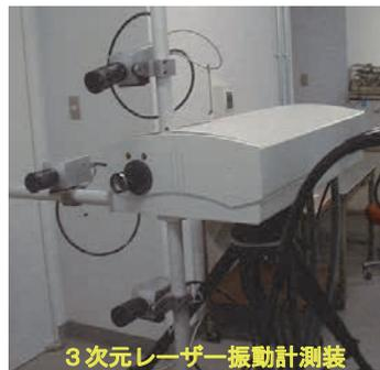
3次元レーザー振動計測装
